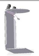
2 Appoggiare il coperchio superiore (A) al lato libero delle due cerniere, verificando che i fori di fissaggio combacino. Fissare quindi il coperchio superiore al lato libero di ogni cerniera con 2 viti di fissaggio
